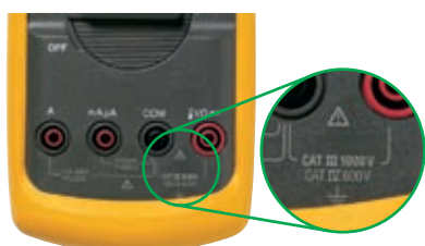
Utilisez des instruments portant les indications suivantes : CAT III 1 000 V, CAT IV 600 V
